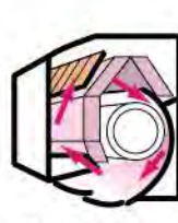
Λειτουργία Θέρμανσης Παροχή υγρασίας στο Φίλτρο για αδρανοποίηση του αλλεργιογόνου
